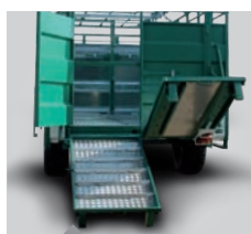
Pont rabattable 2 battants assisté par ressort (photo avec option tôle ALU)
