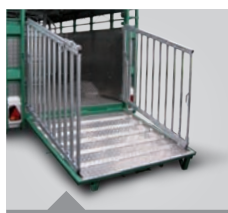
Barrières accordéon sur pont hydraulique (photo avec option tôle ALU)
