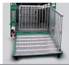
Barrières accordéon sur pont hydraulique (photo avec option tôle ALU)
