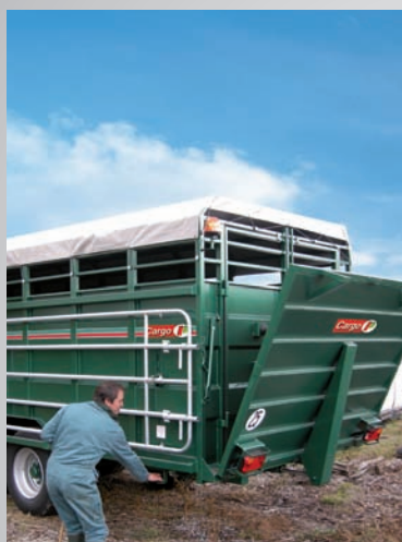
■ 2 portes arrière indépendantes de 90 cm chacune (pont hydraulique en standard)
