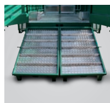
Pont rabattable 2 battants assisté par ressort (photo avec option tôle ALU)
