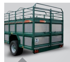
Porte arrière à ouverture intégrale 2.10 m pour gamme HVX
