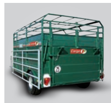
Pont rabattable 2 battants assisté par ressort (photo avec option tôle ALU)
